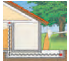
Befüllsystem mit Trog im Erdreich versenkt.
