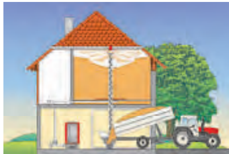
Befüllsystem für Lagerraum im 1. und 2. Stock.
