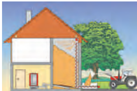
Befüllsystem für zweistöckigen Lagerraum.
