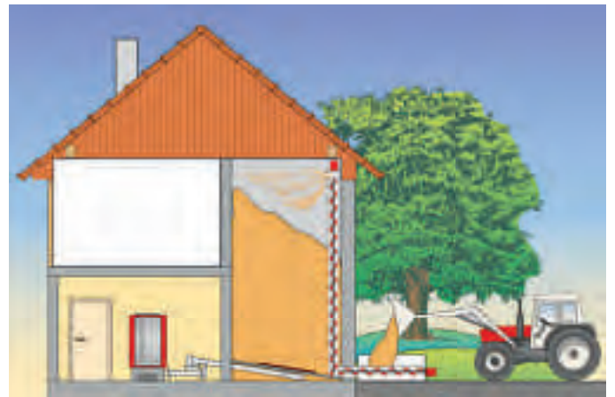
Großes Hackgutlager ebenerdig mit senkrechter Befüllschnecke.
